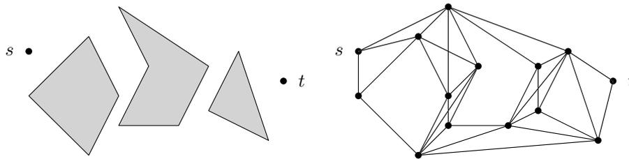
この問題は以下の方法を用いて多項式時間で解くことができる。まず、可視性グラフ (visibility graph) を構成する。これは、指定された始点と終点、そして、多角形障害物の頂点を頂点集合とするグラフであり、辺は障害物に遮られずに互いに見ることのできる頂点間にすべて引く(上の右図参照)。各辺の長さをその端点間のユークリッド距離とする。これは多角形障害物の頂点総数が  $n$  であり、可視性グラフの辺数が  $m$  であるとき、 $O(m + n \log n)$  時間で計算できる [GM91]。
